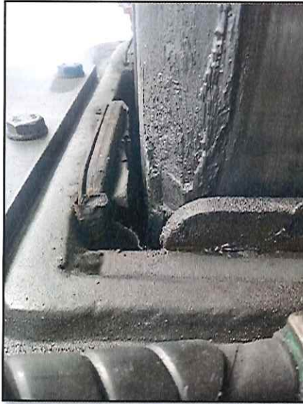
Local: Spreader Item # 18: desgaste nos calços deslizantes das asas telescópicas do spreader.
