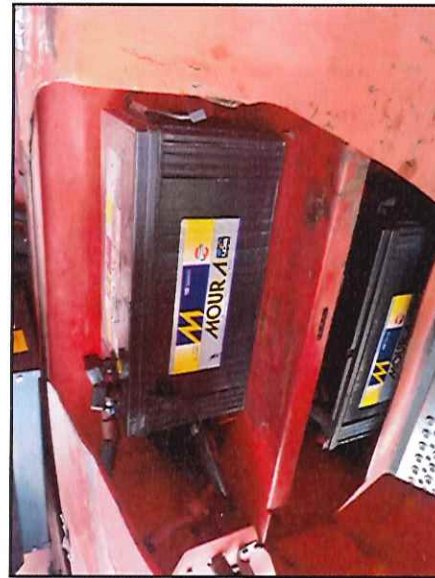
Local: Chassi Item # 35: bateria se encontra solta dentro do compartimento de baterias.
