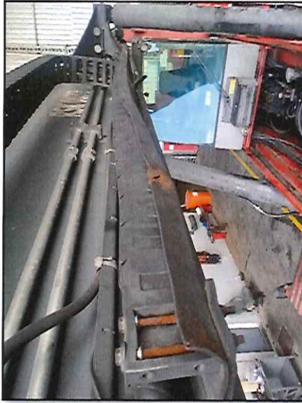
Local: Lança Item # 44: calha do cable track da lança amassada.
